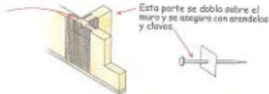
Antes de fijar las mallas con los clavos, los sujetamos con las salientes de los conectores.
