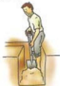
\* La profundidad de la excavación es de 60 cm mínimo; si el suelo es firme a esa profundidad, De lo contrario, seguir excavando hasta encontrar suelo duro.
