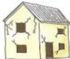
\* Los muros son muy largos, altos y con muros muy delgados como para resistir 2 pisos.
